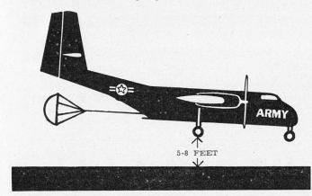
In einer Übung der 11. Luftangriffsdivision wurden Versorgungsgüter wie Munition und Treibstoff in Einzellasten abgeworfen, die bis zu 2250 kg schwer waren. Obschon bei diesem System der Aufprall äußerst gering ist, müssen die Transportgüter mit einer wabenartigen Verpackung geschützt werden.
