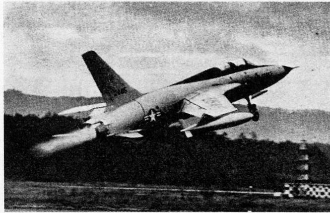
**Technische Daten:** Spannweite 10,64 m; Länge 20,38 m; Höhe 6 m; Leergewicht 12,475 t; maximales Abfluggewicht 21,955 t; maximale Geschwindigkeit in 11600 m Höhe Mach 2,25; maximale Geschwindigkeit in Bodennähe Mach 1,25; Gipfelhöhe 15850 m; maximale Reichweite mit Zusatztanks 6820 km. Bewaffnung: 20-mm-Kanone, konventionelle und nukleare Bomben, «Sidewinder»- und «Bullpup»-Flugkörper.
