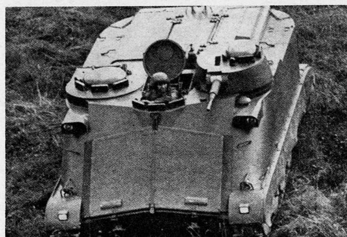
Der Antrieb erfolgt durch einen 270 HP leistenden «Volvo»-Dieselmotor, der dem Fahrzeug auf der Straße eine Geschwindigkeit von gut 60 km/h und in ruhigem Wasser von gut 7 km/h verleiht. Zur Erhöhung der Geschwindigkeit im Wasser wurden seitlich der Raupen Gummischürzen montiert. Die Gewichtsverteilung kann während des Schwimmens mit Trimmtanks ausgeglichen werden. PS
