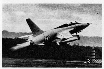
Technische Daten: Spannweite 10,64 m; Länge 20,38 m; Höhe 6 m; Leergewicht 12,475 t; maximales Abfluggewicht 21,955 t; maximale Geschwindigkeit in 11600 m Höhe Mach 2,25; maximale Geschwindigkeit in Bodennähe Mach 1,25; Gipfelhöhe 15850 m; maximale Reichweite mit Zusatztanks 6820 km. Bewaffnung: 20-mm-Kanone, konventionelle und nukleare Bomben, «Sidewinder»- und «Bullpup»-Flugkörper. («Soldat und Technik» Nr. 2/1964)
