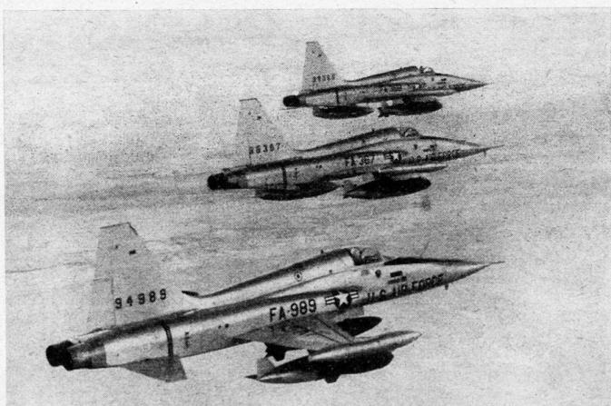
Die F5 verfügt über zwei Triebwerke General Electric J85-13 mit Nachbrenner und einem Schub von 3628 kg, erreicht eine Höchstgeschwindigkeit von 1600 km/h und eine höchste Flughöhe von 16400 m ü. M. Die Steigfähigkeit beträgt 9144 m/min auf Meereshöhe. WM
