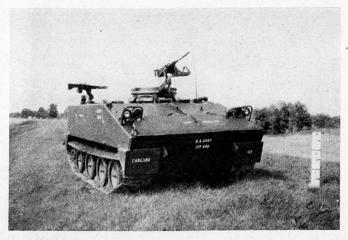
bar; ein 7,62-mm-Maschinengewehr M 60, links oder hinter der Beobachterluke lafettierbar, abnehmbar; Panzerung: Aluminium, schützt vor kleinkalibrigen Infanteriewaffen und Geschoßsplittern; Gewicht etwa 7,5 t, lufttransportier- und abwerfbar; Breite 2,34 m; Höhe 2,29 m. Wenderadius 2,74 m. Schwimmfähigkeit wie M 59 und M 113 ohne spezielle Vorbereitungen, nicht zu große Strömung, keine Unterwasserhindernisse.
