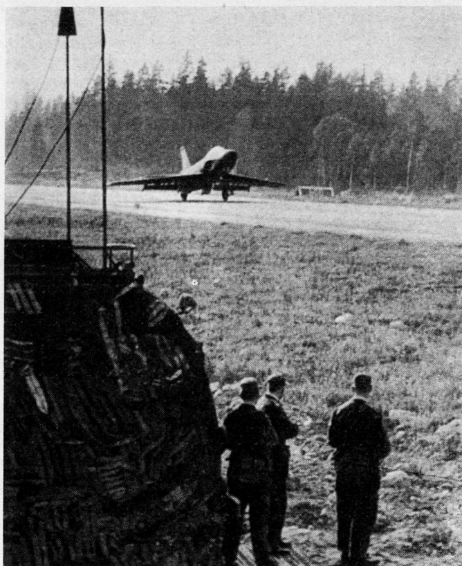
Bild 1. Zuweilen müssen die «Lansen» mehrere Kilometer rollen oder sich schleppen lassen, um von den rückwärtigen Stellungen zu den Straßenstartbahnen zu gelangen
