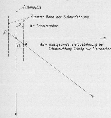
Bild 3. Schema für die Berechnung der Treffererwartung bei Artilleriefeuer
