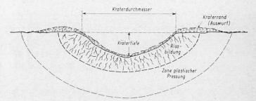
Bild I. Schematische Darstellung der Kraterdimensionen (für die 20-kt-Bombe wird der Durchmesser ~ 100 m, die Kratertiefe ~ 25 m, die Auswurfhöhe [Kraterrand] etwa 5 m) Nach amerikanischen Angaben 1962; vergleiche auch Tabelle I.I
