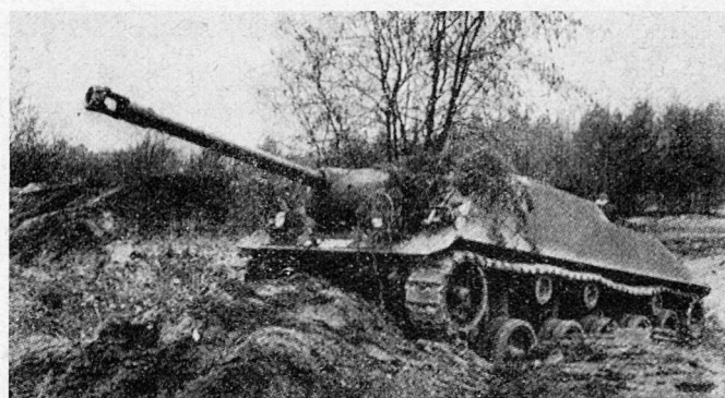
Bild 4. Der neue deutsche Kanonenjagdpanzer. Gewicht: 23 t, Bewaffnung: 9-cm-Kanone, Besatzung: 4 Mann. Dieses Fahrzeug soll noch dieses Jahr in der deutschen Armee zur Einführung gelangen
