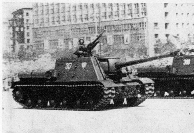
Bild 5. Der russische Jagdpanzer JSU 122 verfügt über dieselbe Kanone wie der schwere Kampfpanzer JS III. Gewicht: 46 t, Besatzung: 5 Mann, starke Panzerung
