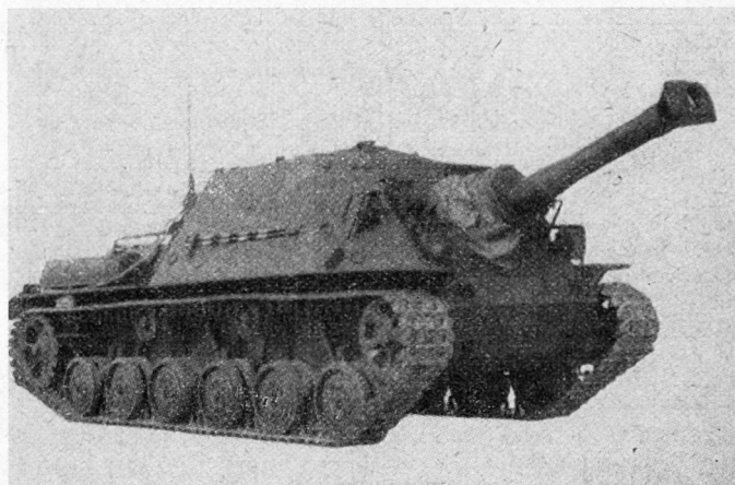
Bild 3. In den fünfziger Jahren wurde dieses leichte Sturmgeschütz mit einer 10,5-cm-Kanone in der schwedischen Armee eingeführt. Das Fahrzeug verfügt über eine gute Geländegängigkeit, ist aber zu leicht gepanzert. Gewicht: 9 t
