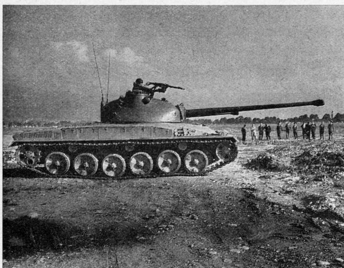
Bild 1. Die endgültige Version des schweizerischen Panzerkampfwagens, «Panzer 61», wird mit einem 10,5-cm-Geschütz ausgerüstet sein. Unser Bild zeigt den Prototyp «Panzer 58», ausgerüstet mit einem 9-cm-Geschütz
