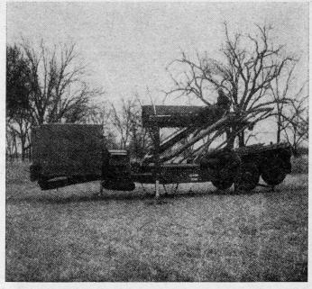
Bild 2 Abschußrampe im Aufbau, nach Abhängen des Schleppers
