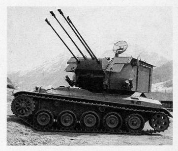
Bild 2. Prototyp eines schweizerischen Flabpanzers auf Chassis AMX mit Oerlikon-20-mm-Vierling
