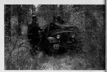
Bild 2. Die rückstoßfreie Panzerabwehrkanone 10,6 cm in einer ungedeckten Feuerstellung. Das leistungsmäßig gute Geschütz ist wegen des Rückstrahls rasch zu erkennen, die taktische Beweglichkeit wegen der fehlenden Panzerung fraglich
