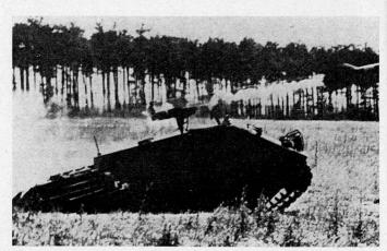
Bilder 3 und 4. Der Raketenjagdpanzer der deutschen Bundeswehr auf Chassis HS 30, ausgerüstet mit zwei versenkbaren Abschußrampen für Lenkraketen SS 11 mit einer Höchstkampfweite von über 3 km
