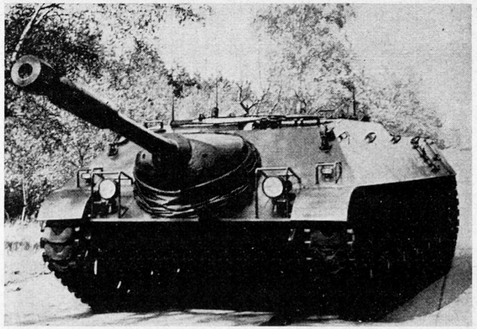
Bild 5. Der Kanonenjagdpanzer der deutschen Bundeswehr mit einer Kanone 9 cm mit großer V o . Das Fahrzeug ist sehr schnell und beweglich
