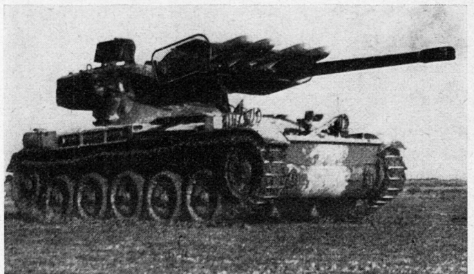
Bild 6. Kombination von Geschütz und Rakete durch Aufbau von Abschußbrampen für die Rakete SS 11 auf dem leichten Panzer AMX 13
