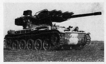
Bild 6. Kombination von Geschütz und Rakete durch Aufbau von Abschußrampen für die Rakete SSII auf dem leichten Panzer AMXI3
