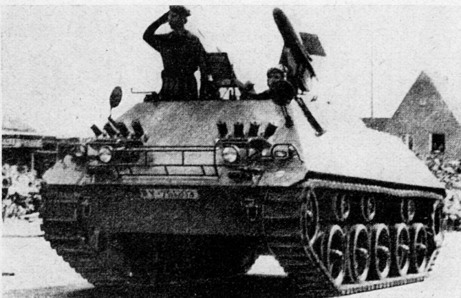
Bilder 3 und 4. Der Raketenjagdpanzer der deutschen Bundeswehr auf Chassis HS30, ausgerüstet mit zwei versenkbaren Abschußrampen für Lenkraketen SS11 mit einer Höchstkampfwerte von über 3 km
