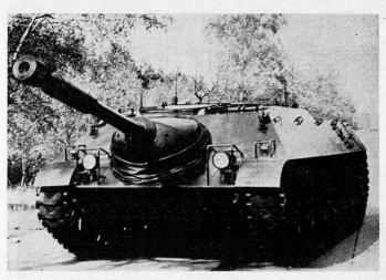
Bild 5. Der Kanonenjagdpanzer der deutschen Bundeswehr mit einer Kanone 9 cm mit großer V°. Das Fahrzeug ist sehr schnell und beweglich
