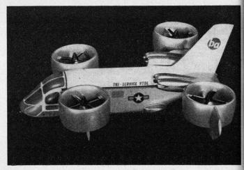
Bild 21. Bell X 22 mit vier schwenkbaren verschalten Propellernt Vier Turbotriebwerke liefern den Antrieb.
