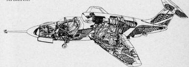
Bild 18. Ryan-VTOL-Flugzeug. In dieser Darstellung erkennt man deutlich die Flügel- und Nasengebläse sowie die Abgasleitungen zu diesen Gebläsen.
