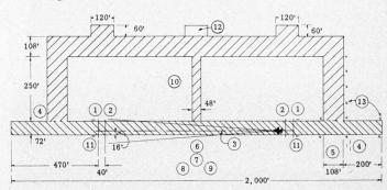
Bild 13. Schema eines STOL-Flugplatzes. Dimensionenangaben in «Fuß»
