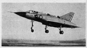
Bild 15. Mirage «Balzac» im Schwebeflug. Die Gitter der Lufteinläufe der Triebwerke für Senkrechtflug sind oben auf der Maschine gut sichtbar. Unten am Rumpfe sieht man die Düsenaustritte.
