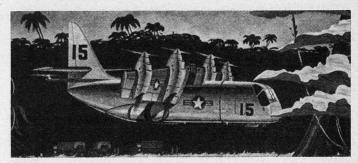
Bild 19. Chance-Vought-Hiller-VTOL-Transportflugzeug. Der ganze Flügel wird für Start und Landung gekippt. In dieser Zeichnung hat der Übergang zum Vorwärtsflug bereits begonnen.
