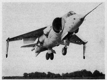
Bild 16. Hawker 1127 im Schwebeflug. Man beachte die nach unten gerichteten Schubdüsen. Diese sind schwenkbar und im waagrechten Flug nach hinten gerichtet.
