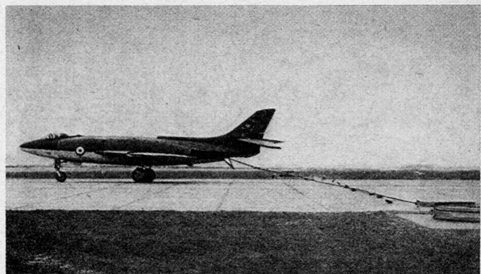
Bild 11. Drei Phasen der Bremsung eines Flugzeuges. Die schlangenartige Deformation des Nylonbandes vermittelt ein gutes Bild der im Spiel stehenden Kräfte. – Phase I: vor dem Fang; Phase II: Beginn der Bremsung; Phase III: Bremsung in vollem Gang
