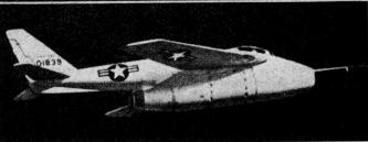
Bild 3. Rechter Teil: Das amerikanische Versuchsflugzeug Bell X 5, obere Abbildung mit normaler, untere Abbildung mit maximal gepfeilter Flügelstellung. – Linker Teil: Planzeichnung mit eingezeichneter Flügelstellung für Langsamflug und Schnellflug. Die Vergrößerung der Spannweite und Reduktion der Pfeilung ergibt kleine Landegeschwindigkeiten
