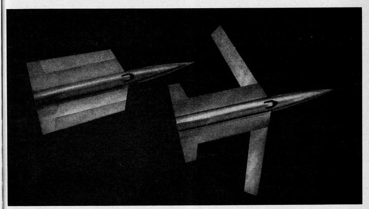
Bild 4. Schematische Darstellung der möglichen Flügelform des amerikanischen Prototyps TFX. Man sieht links die Flügel in Schnellfluglage und rechts entfaltet für Start und Landung
