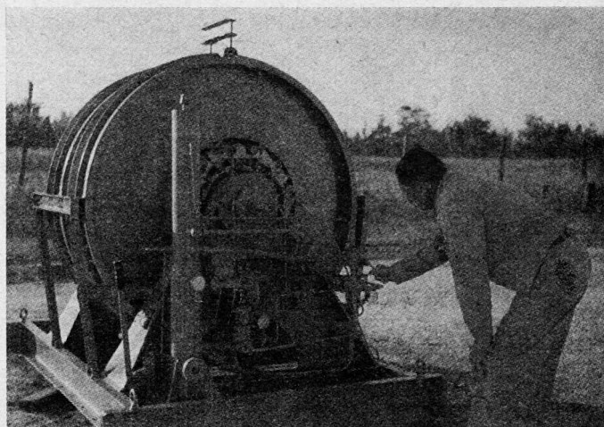
Bild 10. Bremse der Firma Bliss & Co. (USA). Man sieht die in der Trommel eingebaute Bremse und die Steueranlage, die erlaubt, die Bremskräfte dem Gewicht und der Geschwindigkeit des Flugzeuges anzupassen
