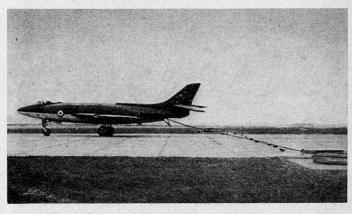
Bild 11. Drei Phasen der Bremsung eines Flugzeuges. Die schlangenartige Deformation des Nylonbandes vermittelt ein gutes Bild der im Spiel stehenden Kräfte. – Phase I: vor dem Fang; Phase II: Beginn der Bremsung; Phase III: Bremsung in vollem Gang
