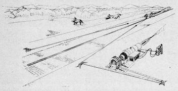
Bild 9. Schematische Darstellung der Installation einer Katapulteinrichtung auf einem Feldflugplatz. Die Führungsschiene auf der Piste konnte eliminiert werden
