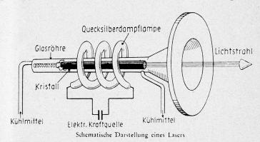
3000 kW bei Dauerbetrieb des Lasers. Davon werden, wie bereits erwähnt, nur etwa 0,03 % im Fluoreszenzlicht ausgenützt, der Rest wird in Wärme verwandelt und muß vom Kühlmittel abtransportiert werden, wenn die ganze Apparatur nicht in kürzester Zeit zerstört sein soll. Hier liegen die ernsthaftesten Schwierigkeiten für den Dauerbetrieb eines Kristallasers.
