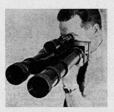
Einen Lichtstrahl-Entfernungsmesser hat die amerikanische Hughes Aircraft Company entwikkelt, mit dem Entfernungen von Objekten in Größe eines Panzers bis zu 12 km genauestens bestimmt werden können. Das Gerät «schießt» durch das rechte Rohr einen Laser-Lichtstrahl auf das Objekt und nimmt den reflektierten Strahl durch das linke Rohr wieder auf. Durch das darüber be-
