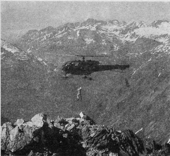
Bild 3. Alouette III, Rettungseinsatz auf 2500 m Höhe Transportiert sechs Passagiere oder zirka 800 kg Fracht mit Treibstoff für zirka 45 Minuten Flugzeit bis auf 3000 m über Meer. 600 kg Fracht können bis auf die höchsten militärisch wünschbaren Landeorte der Alpen befördert werden. Die Kabine bietet nötigenfalls Platz für zwei liegende Verwundete und zusätzlich einen Betreuer
