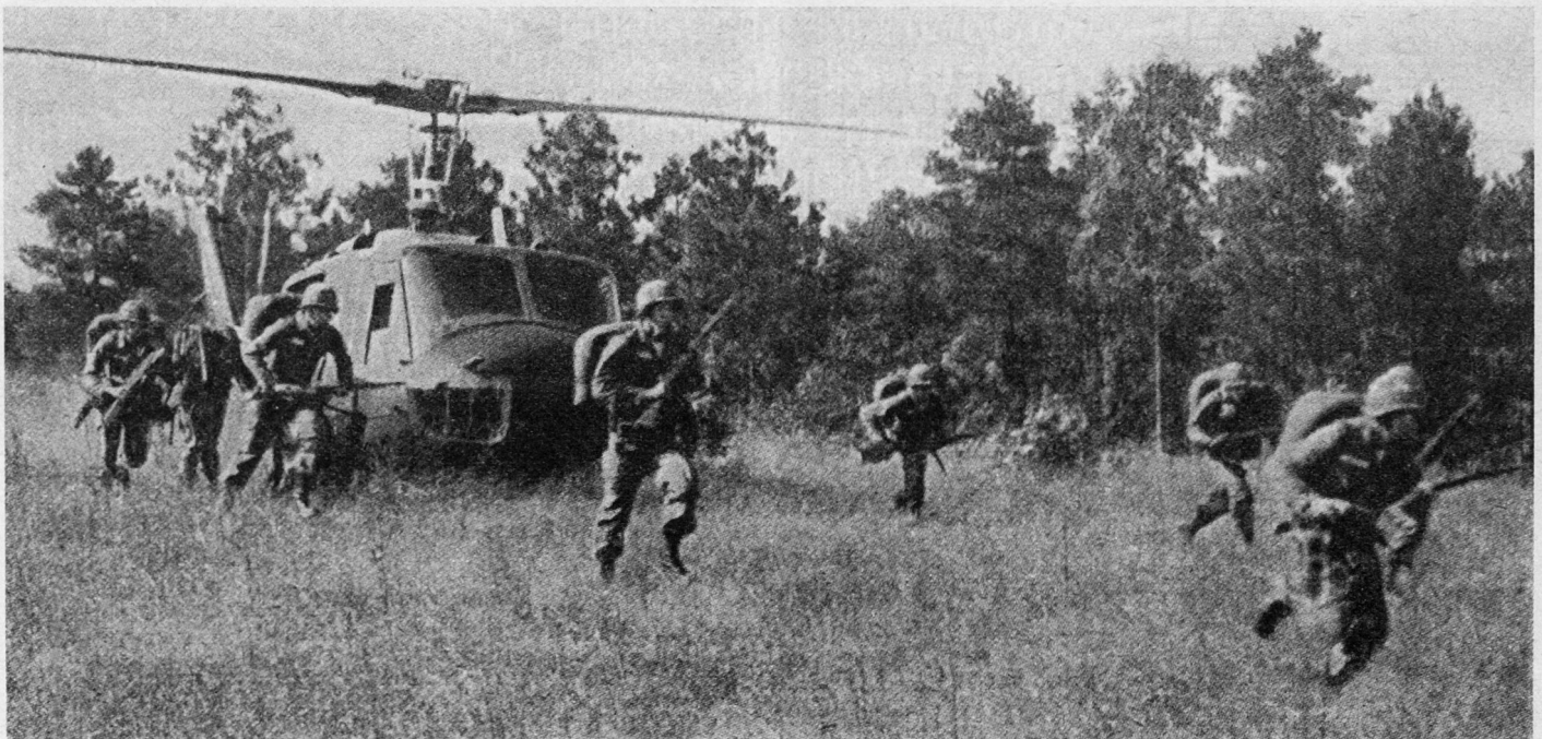
Bild 6. Bell UH-1D (Weiterentwicklung des UH-1B Iroquis), transportiert zwölf voll ausgerüstete Soldaten über 475 km oder sechs liegende Verwundete mit einem Betreuer, oder drei liegende und vier sitzende Verwundete mit einem Betreuer; kann bewaffnet werden mit 7,26-mm-Feuerturm, oder Nord-SS-11-Panzerabwehrraketen, oder 2,75-Zoll-Faltflossenraketen
