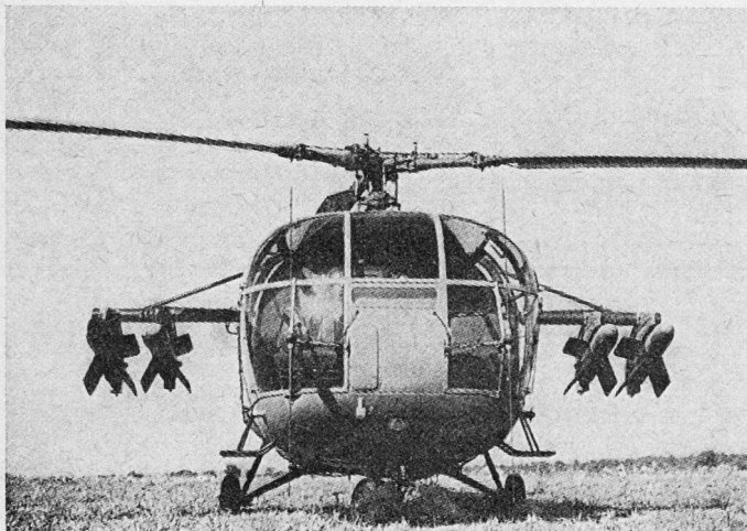
Bild 8. Alouette III mit Panzerabwehrraketen SS-11
