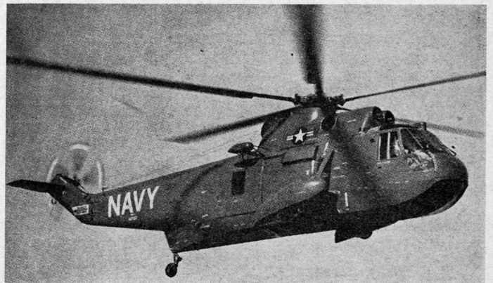
Bild 17. Sikorsky HSS-2 mit 2 Gasturbinen zu je 1050 PS Die Maschine wiegt maximal 8 Tonnen und kann bis 2,2 Tonnen Last mitnehmen. Rotordurchmesser 19 m
