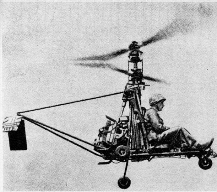
bereits nach kurzer Ausbildungszeit gefahrlos geflogen werden können. Der Hubschrauber ist ungefähr 250 kg schwer, ist mit einem luftgekühlten Porsche-Motor ausgerüstet, und die zulässige Laufzeit bis zur ersten Grundüberholung beträgt 1000 Betriebsstunden. («Soldat und Technik», 1/1962.) PR
