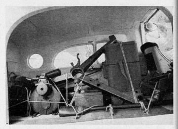
Abb. 2. Pilatus Porter 340 PS. Verlad einer 20-mm-Flab-Kanone «Oerlikon» inklusive 3 × 100 Schuß Munition. Gewicht total 520 kg
