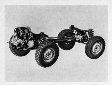
Blick auf das Fahrgestell mit hintenliegendem, luftgekühltem Zweizylindermotor, Zentraltragrohr und Schraubenfedern der vorderen und hinteren Schwingachsen
