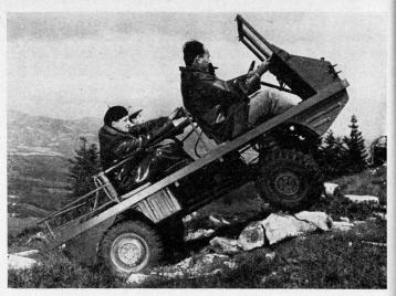
Geländelastwagen Haflinger bei Steigversuchen im Gelände Für den Einsatz in der Armee dürfen keine Personen auf der Ladebrücke transportiert werden
