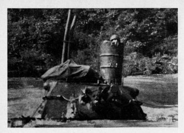
Der amerikanische Panzerkampfwagen M-60, vorbereitet zum Durchwaten eines Gewässers
