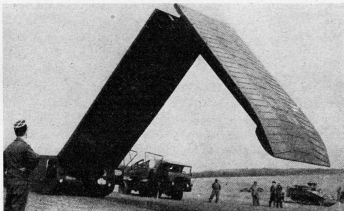
4. Französische Sturmbrücke, bei der das Brückenfahrzeug gleichzeitig als Ponton verwendet werden kann
