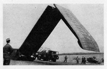
Französische Sturmbrücke, bei der das Brückenfahrzeug gleichzeitig als Ponton verwendet werden kann
