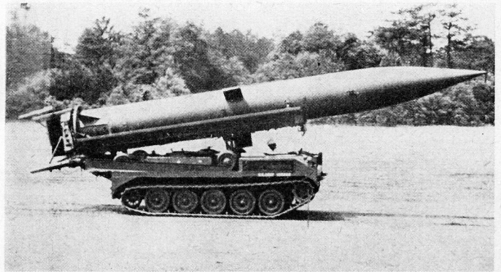
«Pershing» auf Selbstfahr-Werfer XM-474. Zum Abschuß wird die Lenkwaaffe senkrecht gestellt
