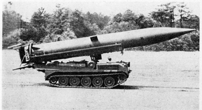
«Pershing» auf Selbstfahr-Werfer XM-474. Zum Abschuß wird die LenkwaFFE senkrecht gestellt
