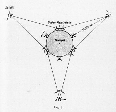
Drei Satelliten im Abstand von 35 800 km auf 24-Stunden-Umlaufbahnen (quasistationäre Satelliten für Übermittlungszwecke). Satellitenbewegung und Erdrotation verlaufen in gleicher Richtung, so daß jeder Satellit zur Erdoberfläche eine konstante Lage einnimmt. Die untere Karte zeigt das Gesichtsfeld jedes Satelliten. Eingezeichnet sind mögliche Standorte von Relais- und Terminalstationen nach einem bestehenden kommerziellen Projekt
