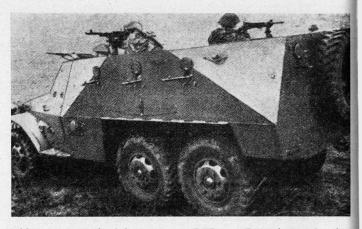
Bild 4. Der russische Schützenpanzer BTR 152. Das Fahrzeug ist oben offen. Die Wirkung der nicht lafettierten Waffen ist sehr fragwürdig
