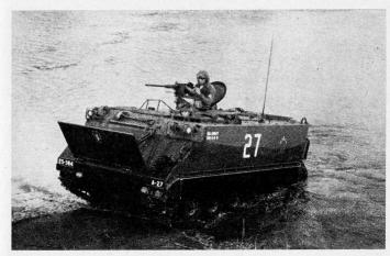
Bild 1. Der amerikanische Standard-Schützenpanzer M 113, bewaffnet mit einem überschweren Maschinengewehr. Der Mannschaftsraum ist vollständig geschlossen
