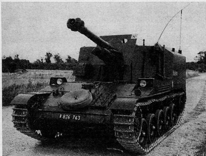
Frühes Modell der Selbstfahrraubitze, in dem der Kampfraum nicht als drehbarer Turm konstruiert ist
