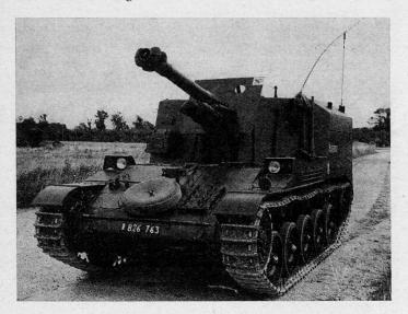
Frühes Modell der Selbstfahrhaubitze, in dem der Kampfraum nicht als drehbarer Turm konstruiert ist
