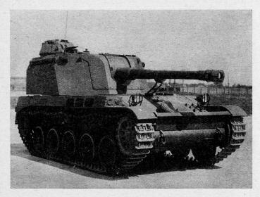
Weiterentwicklung der Selbstfahrhaubitze mit drehbarem Turm, auf dem eine ebenfalls drehbare Mg-Kuppel aufgebaut ist
