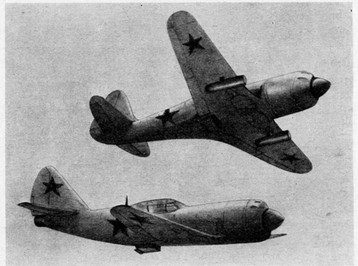
Bild 4. LA-9 mit zwei unter den Flügeln angehängten Pulsoreaktoren als Zusatztriebwerken zum Chvetzov-Sternmotor von etwa 2200 PS. Mit diesen Düsen-Zusatztriebwerken unternahmen die Sowjets in den ersten Nachkriegsjahren die ersten «Gehversuche» mit Düsenantrieb.
