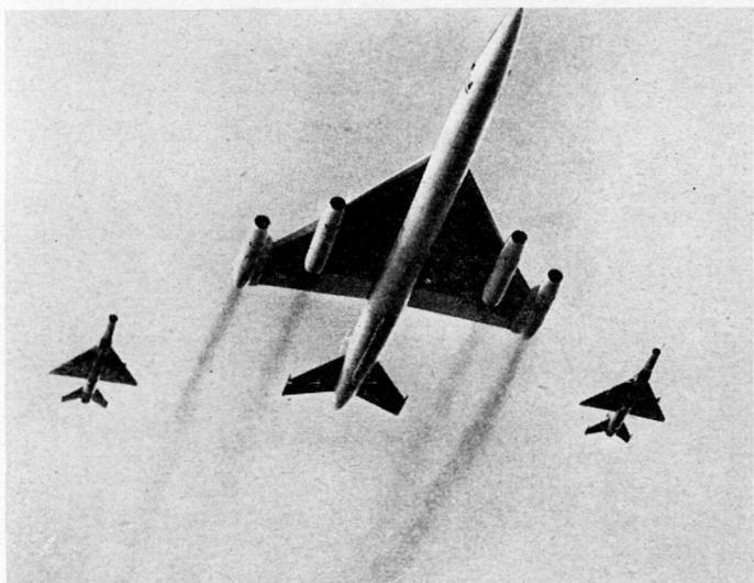
Imponierend und unzweifelhaft auch aerodynamisch homogen ist dieser schwere interkontinentale Bomber der Mya-Klasse, der von der NATO mit «Bounder» bezeichnet wurde. Diese hier abgebildete Version unterscheidet sich jedoch vom früheren «Bounder» durch einige technische Änderungen. Insbesondere ist die Unterbringung von zwei Düsentreibwerken an den Flügelenden neu und bemerkenswert.
