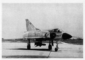
Mirage III, zum Luftkampf ausgerüstet mit 2 Kanonen 30 mm und 250 Schuß, 1 Lenkgeschoß Matra 530 mit Infrarot- oder Radarsuchkopf
