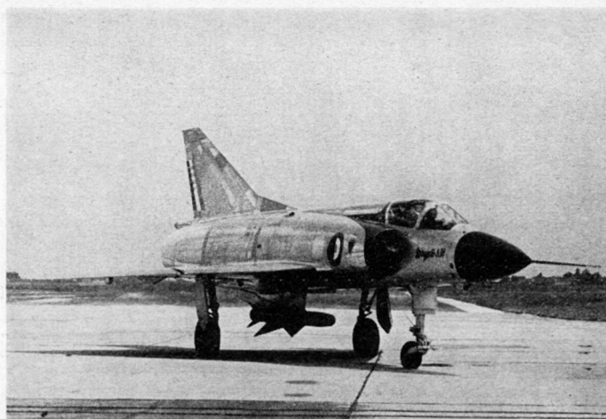
Mirage III, zum Luftkampf ausgerüstet mit 2 Kanonen 30 mm und 250 Schuß, 1 Lenkgeschob Matra 530 mit Infrarot- oder Radarsuchkopf
