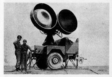
Bild 5. Beleuchtungs-Radar für die USA-Flab-Lenkwaffe «Hawk»
