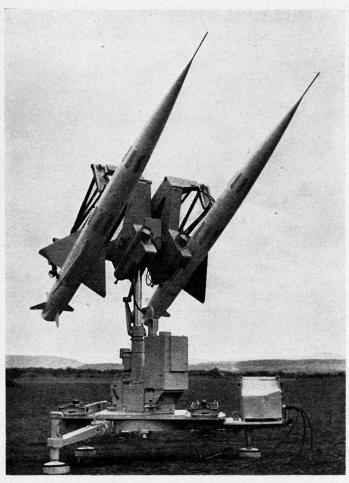
Bild 12. Feuerbereite Langstrecken-Flab-Lenkwaffe «Oerlikon» auf Doppelwerfer
