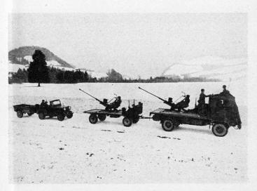
Bild I Flab-Gruppe mit improvisierter Selbstfahrlafettierung auf Lastwagen und Gepäckanhänger
