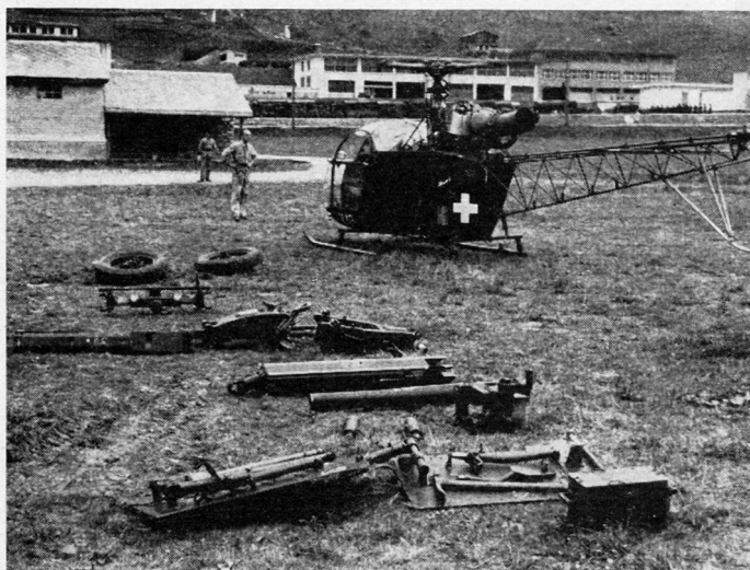
Bild 2. 7,5 Gebirgskanone, in Bastlasten zerlegt
