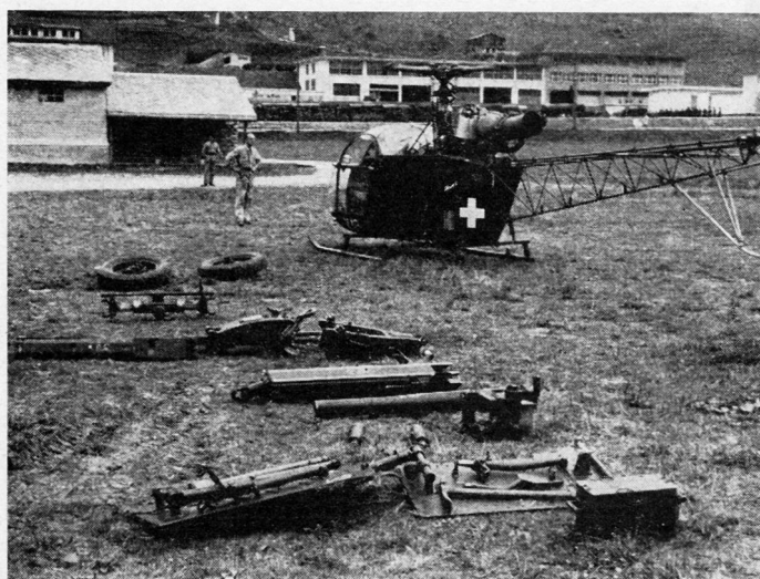
Bild 2. 7,5 Gebirgskanone, in Bastlasten zerlegt
