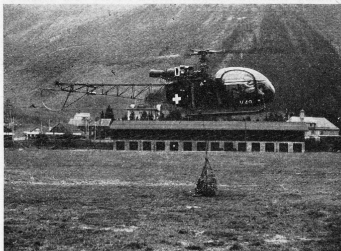
Bild 4. Volles Tragnetz am schwebenden Helikopter (Typ Alouette) angehängt
