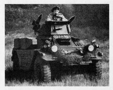
Bild 3. Panzerabwehr-Lenkwaffe «Vigilant» für Panzerspäherwagen
