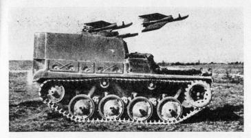
Bild 2. Hotchkiss-Selbstfahr-Werfer mit 4 Panzerabwehr-Lenkwaffen
