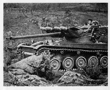
Bild 4. Leichtpanzer AMX der französischen Armee mit 4 Panzerabwehr-Lenkwaffen SS11
