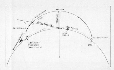
Fig. 2. Radar-Sichtverhältnisse für einen 5000 Meilen-Raketenflug
