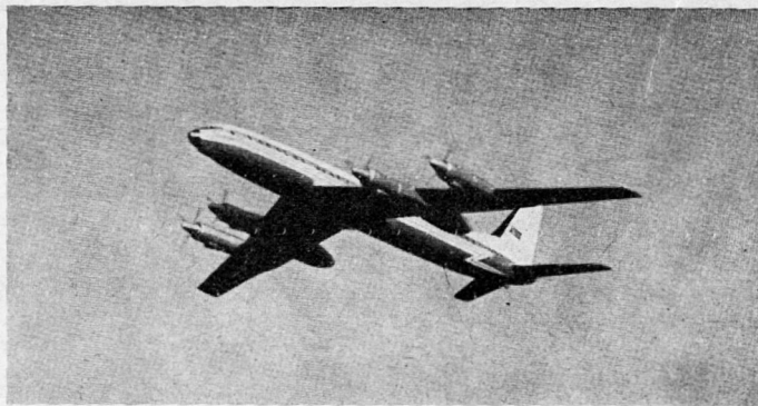
Bild 5. TU-114 «Rossiya» Transportflugzeug, das aus dem TU-20-Bombardierungsflugzeug entwickelt worden ist. Tragfähigkeit 220 Personen bei 800 km/h.
