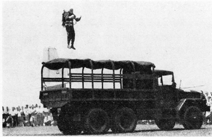
Das Gerät besteht aus einem doppelten Düsenantrieb, der mit Wasserstoffperoxyd betrieben wird und auf einem Korsett aus Fiberglas befestigt ist. Der «Pilot» beeinflußt die Richtung, indem er mit einem Hebel einen der Antriebe schwenkt, während die andere Hand mit einem Gashebel – ähnlich wie bei einem Motorrad – die Antriebsleistung steuert.
