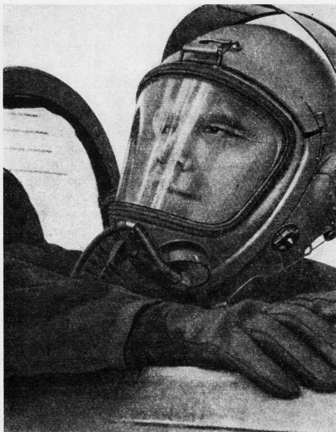
Auch die sowjetischen Jagdpiloten verfügen heute über moderne Fliegerhelme. Man beachte die herunterklappbare Sonnenschutzblende, die den Sichtwinkel nicht beeinträchtigt
