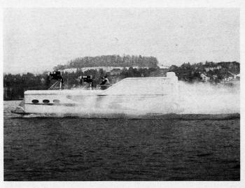
Bild 3. Weilands Luftkissenfahrzeug anläßlich der Probefahrt auf dem Zürichsee vom 19. Februar 1960. Es erzielte eine Geschwindigkeit von 95 Stundenkilometern und wurde von der US-Marine angekauft. Am 15. Mai 1961 wurden in der Marineschule Quantico (USA) Geschwindigkeiten von über 105 km/h erzielt.
