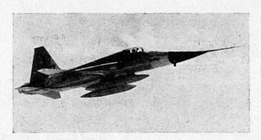
Fig. 1 Der N 156 F mit zwei Napalmbomben unter den Flügeln und einem Behälter am Rumpf, welcher die sechsläufige Maschinenkanone «Vulcan» vom Kaliber 20 mm enthält
