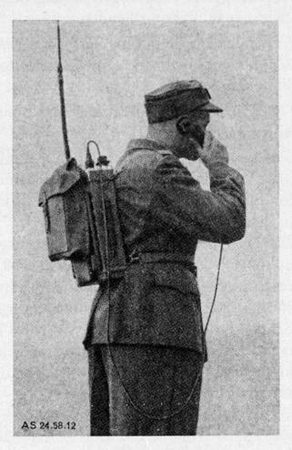
4 Stunden Arbeit pro Tag. Das Gewicht des kompletten Kleinfunkgerätes beträgt 11,3 kg. Die Speisung des Kleinfunkgerätes kann auch durch den *Handgenerator* erfolgen. Mittels Handgenerator wird gegenüber dem Trokkenbatteriebetrieb eine dreimal größere Sendeleistung erzeugt.
