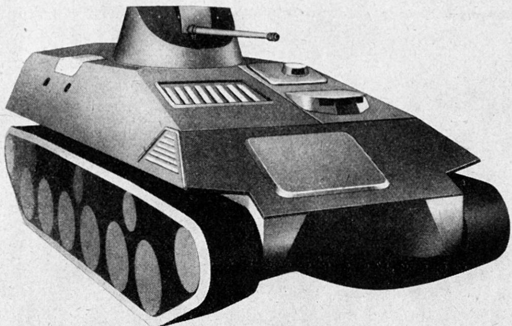
5. *Bewaffnung*. Der TARTARUGA wird auf Grund des KTA-Pflichtenheftes mit einer 20 mm-Oerlikon 204 GK-Kanone ausgerüstet. Die Kanone besitzt einen Seiten-Richtbereich von 360 Grad, eine Depression von minus 10 Grad und eine maximale Elevation von plus 70 Grad. Anstelle der Kanone könnte auch ein Mg. auf einer entsprechend verkleinerten Drehlafette eingebaut werden.
