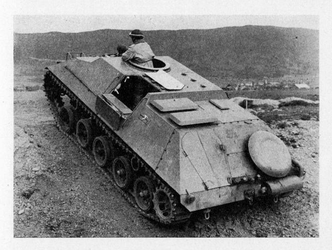
III. Leichtes Hispano-Suiza-Truppentransport-Kettenfahrzeug (Typ TTL)
