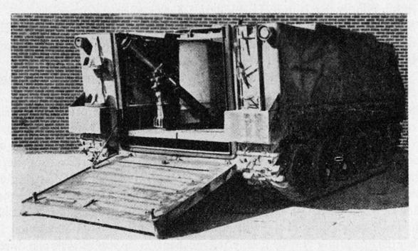
Abb. 4. Amerikanischer Schützenpanzerwagen M 84 mit 106 mm-Mw.
