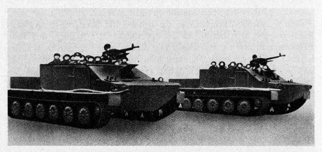
Abb. 1. Russischer Schützenpanzerwagen BTR 50, 15 Mann, schwimmfähig, 40 km/h auf Land, 5 km/h im Wasser, 10 t, Fahrbereich 250 km, 1 Mg. 7,62 mm. Länge 7 m, Breite 3 m, Höhe 2 m. Motor: Diesel.
