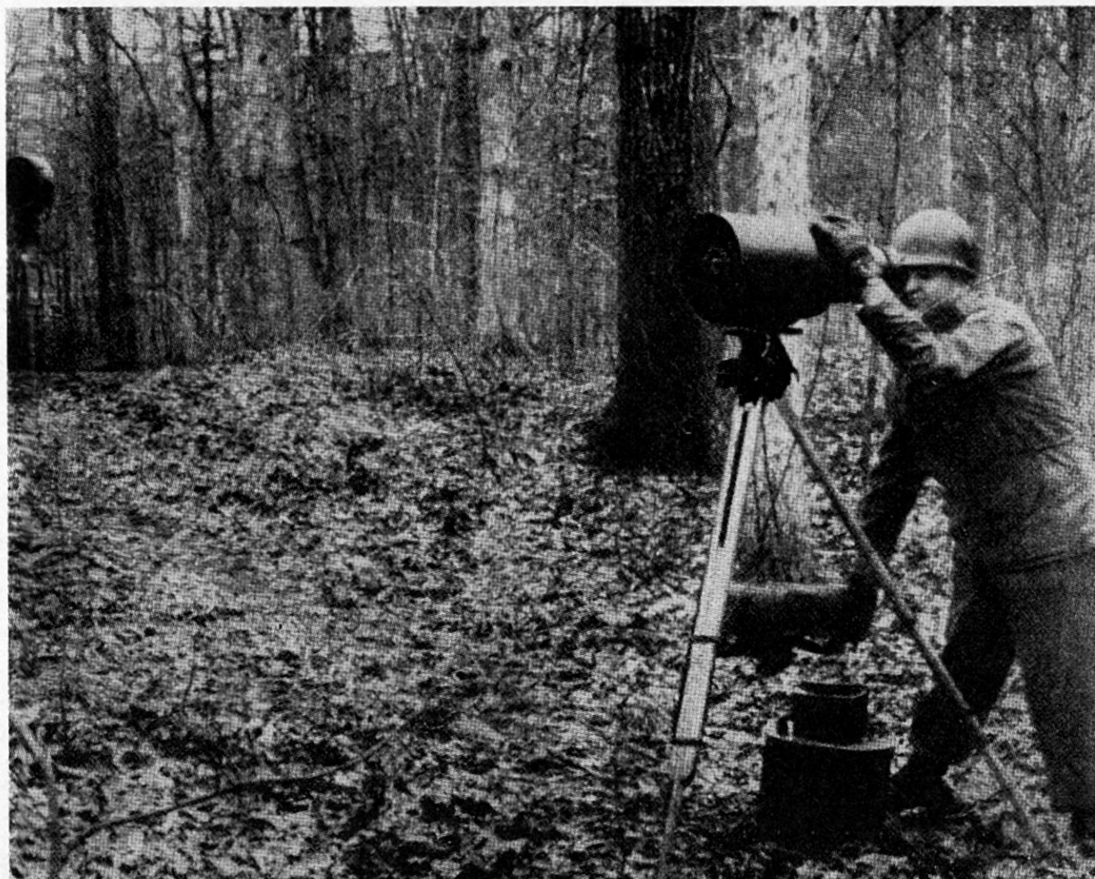
Fig. 5. Ein Beobachtungsgerät für den Bat.Kdt., das mit Infrarot arbeitet, gestattet die Nachtbeobachtung bis auf die Wirkungsdistancen der organischen Bat.Waffen.
