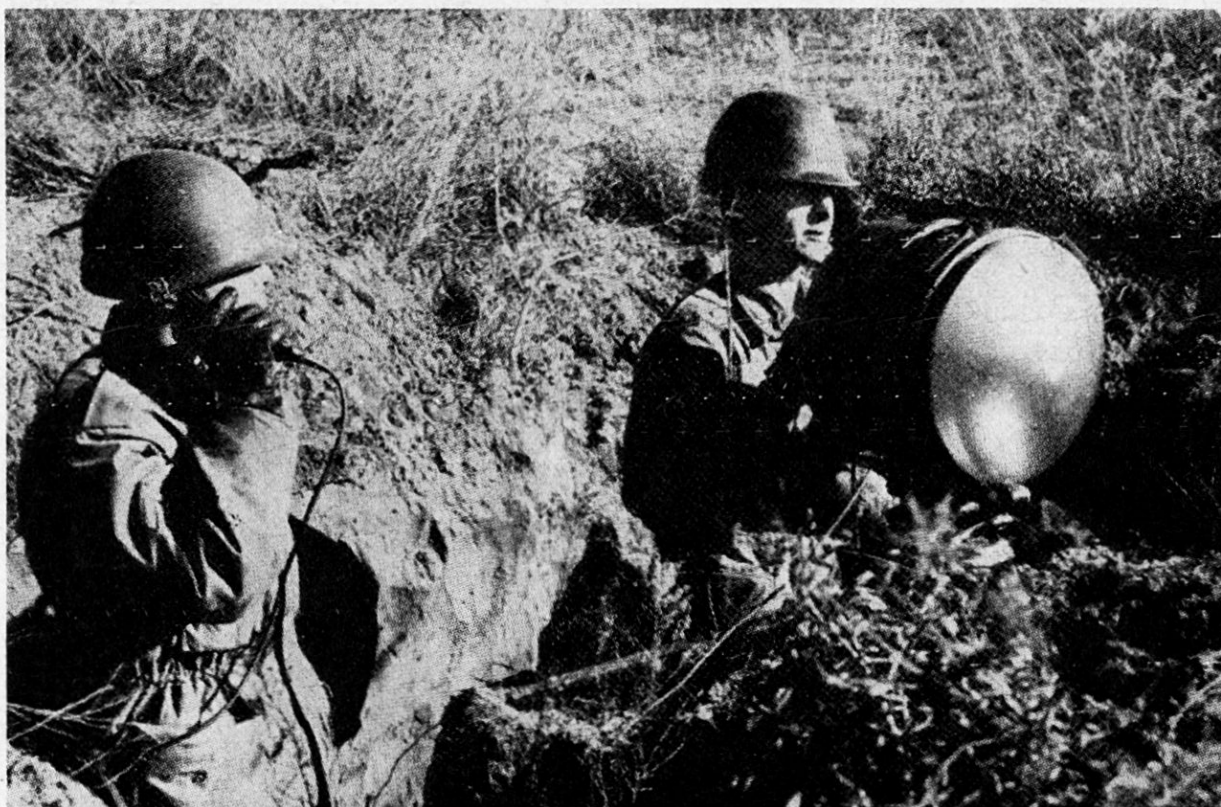
Fig. 4. Neu entwickelte Infrarotfilter für die Scheinwerfer der taktischen Fahrzeuge wie Panzer und gepanzerte Mannschaftstransportfahrzeuge in Verbindung mit einem «navigational automatic position finder», der automatisch jederzeit den Standort des Fahrzeuges in Koordinaten angibt, und zwar tags und nachts. Die Infrarotfilter in Verbindung mit den normalen Scheinwerfern werden den Gebrauch der in Fig. 1 und 3 gezeigten Geräte erleichtern, weil sie das Gelände mit infrarotem Licht überdecken, und werden das Einhalten größerer Nachtgeschwindigkeiten als bis anhin erlauben. Sobald das Fahrzeug als Infrarotquelle entdeckt ist, oder aus andern Gründen das Gerät nicht mehr verwendet werden soll, beleuchten die Scheinwerfer mit sichtbarem Licht das Gefechtsfeld.
