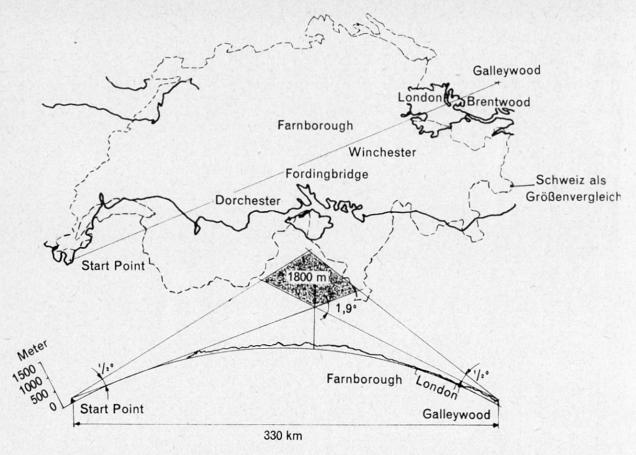
Fig. 10. Streckenprofil einer 200 Meilen-Tropo-Streustrahlstrecke (858 MHz, 24 Telefoniekanäle, 10 kW, 9 m Antennen. Hersteller: Marconi, 1956)
