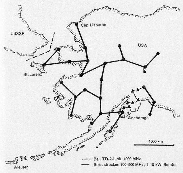
Fig. 6 «White-Alice»-Streustrahl-Verbindungssystem in Alaska. Bauzeit 1955–1958 (Western Electric)
