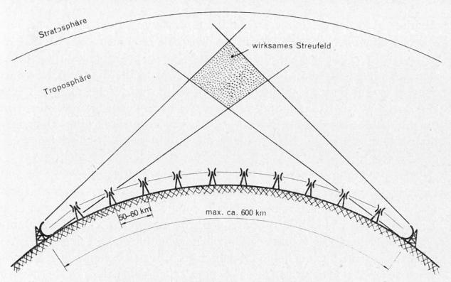
Fig. 3. Troposphärische Streustrahlstrecke. Verglichen mit konventioneller Richtfunkstrecke zu 50–60 km Funkfeldlänge (Erdkrümmung nicht maßstäblich)
