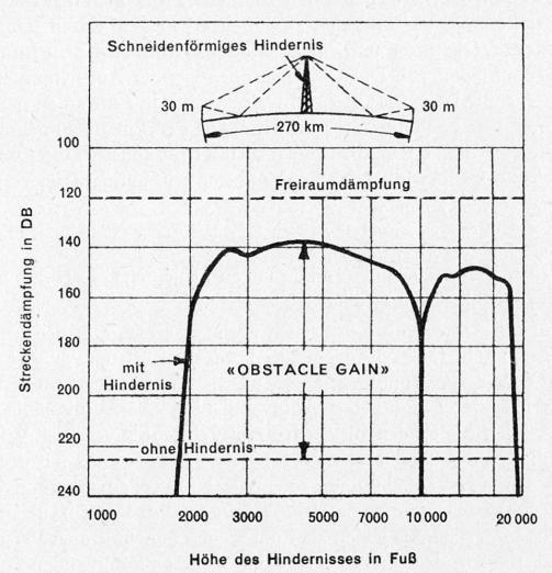
Fig. 1. Obstacle-gain-Diagramm für 100 MHz (aus einem amerikanischen Merkblatt)
