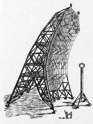
Fig. 4. 30-m-Streustrahlantenne für Windgeschwindigkeiten bis 180 Knoten und 3 m Eisansatz (Die Höhe entspricht jener eines 10 stöckigen Hauses)
