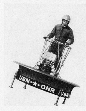
Fig. 4. Plate-forme volante Hiller
