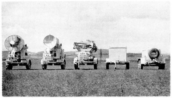
Abb. 1 Bodengeräte der Contraves-Oerlikon Fliegerabwehrraketenbatterie in Fahrstellung. V.l.n.r. Leitstrahlsender, Batterie-Radarrichtgerät, Doppelstartlafette, Rechengerät und Dieselaggregat.
