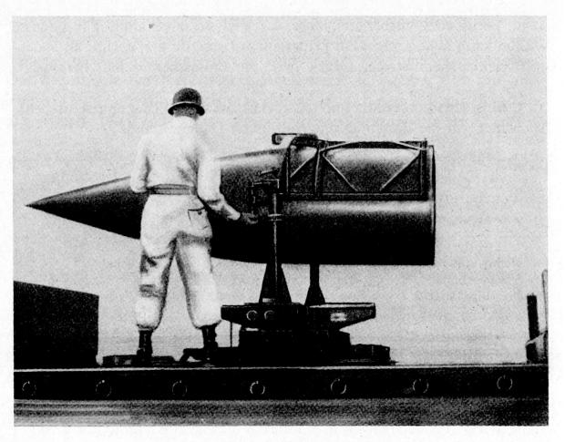
Abb. 14. Boden-Boden-Lenkwaffe «Corporal» Erstellen der Gebrauchsbereitschaft der Lenkwaffe. Der Kriegskopf wird vor dem Zusammenbau überprüft
