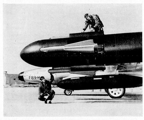
Abb. 13. Luft-Luft-Lenkwaffe «Falcon» Jagdflugzeug F 89 H mit je drei Lenkwaffen, die am Flügel und am Waffenbehälter angebaut sind
