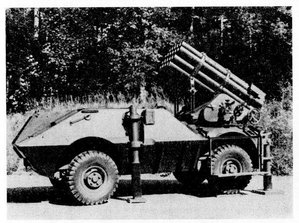
Abb. 8. Boden-Boden-Kurzstrecken-Art.Rakete Gepanzerte Selbstfahrrampe «Mowag» (24fach-Werfer)
