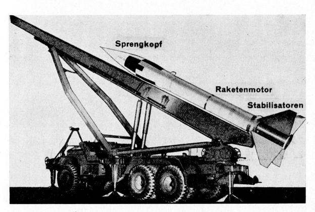
Abb. 2. Kurzstrecken-Raketengeschoß «Honest John» auf Selbstfahrrampe in Abschußstellung für den «geführten Abschuß»
