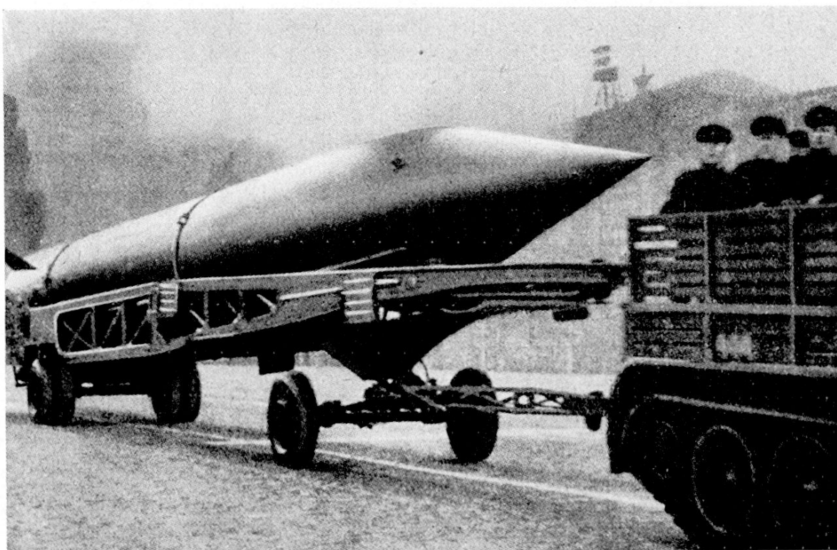
Abb. 7. Boden-Boden-Lenkwaŕfe «T 1» (M 101) Russische taktische Mittelstrecken-Lenkwaŕfe in Transportstellung
