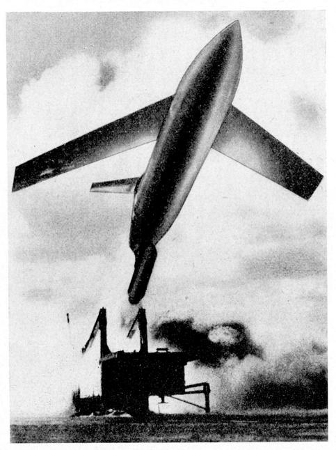
Abb. 3. Taktische Mittelstrecken-Lenkwaffe «Matador» (Null-Punkt-Start). Der längliche schwarze Körper am Heck ist die Startrakete, die nachher abfällt
