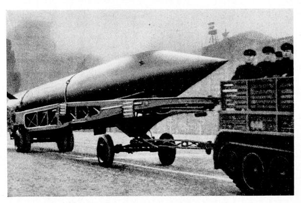
Abb. 7. Boden-Boden-Lenkwaffe «T 1» (M 101) Russische taktische Mittelstrecken-Lenkwaffe in Transportstellung
