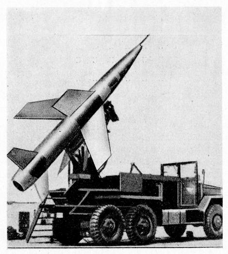
Abb. 6. Boden-Boden-Kurzstrecken-Lenkwaffe «Lacrosse» Der Transport-Lastwagen ist gleichzeitig Abschußrampe
