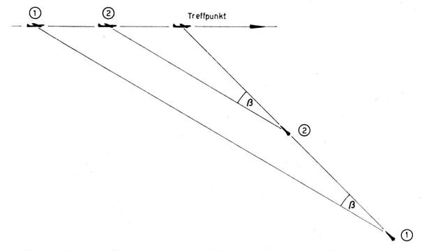
Fig. 6 Ideale Verfolgungsbahn einer Rakete mit konstantem Vorhaltewinkel
