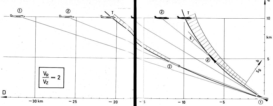
Fig. 3 Verfolgungsbahnen von im Zieldeckungsverfahren gen Raketen auf horizontal fliegende Ziele (Vz = 1000 km/h). Quer zu den Flugbahnen sind die zur Krümmung der Beschleunigungen schraffiert aufgetragen.
