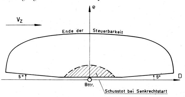
Fig. 2 Wirkbereich vorhaltgelenkter Raketen
