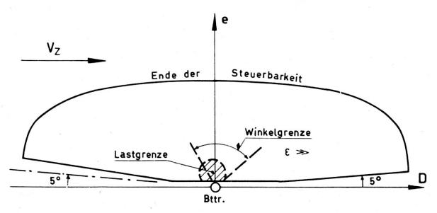
Fig. 4 Wirkbereich der im Zieldeckungsverfahren gelenkten Raketen
