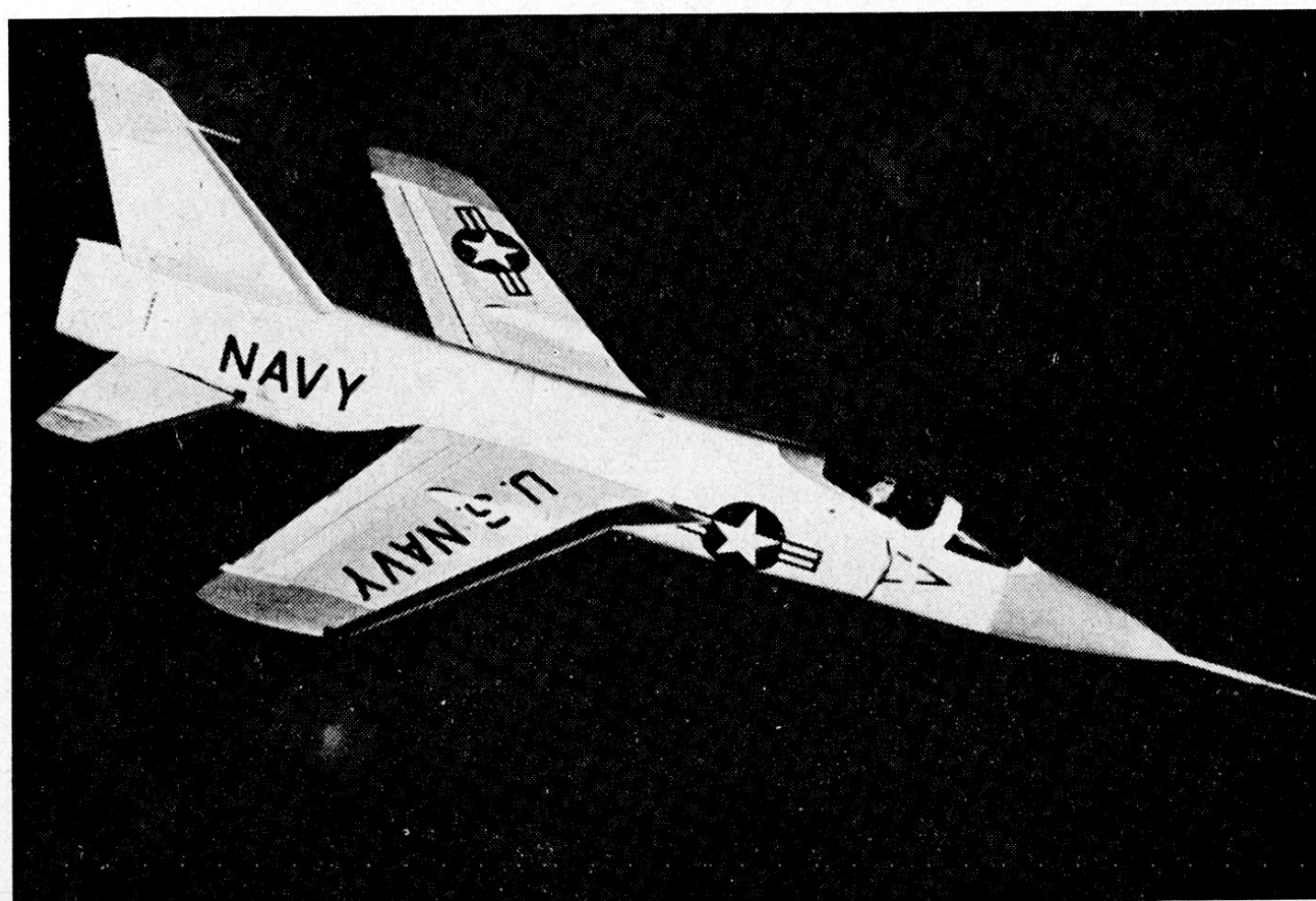
Gruman F 11 F - 1 F «Super Tiger» mit General Electric-J 79-Triebwerk
