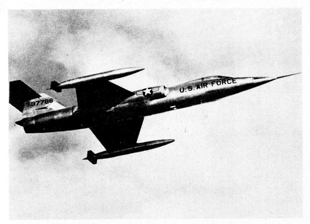
Lockheed F 104 «Starfighter» mit General Electric-J 79-Triebwerk
