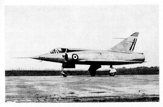
Dassault «Mirage III» mit Mischantrieb SNECMA Atar 9-Düsentriebwerk und SEPR 660-Raketenmotor
